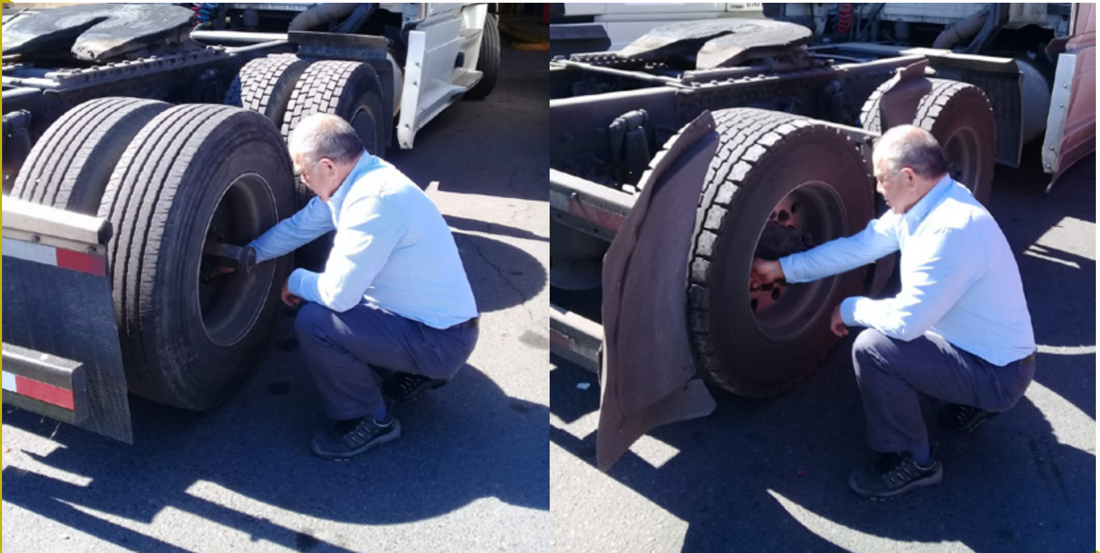
Figura 3. Claudio Bravo realizando inspección de un neumático doble (izquierda) y super ancho (derecha).
