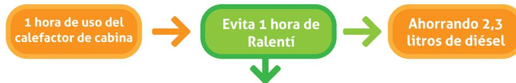
Figura 5. Diagrama de supuestos para el cálculo de ahorro de combustible, por medio del uso del calefactor de cabina.
